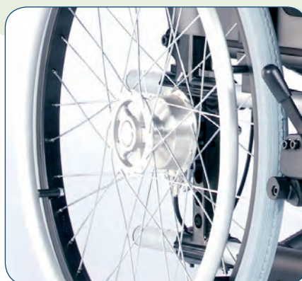
22" und 24" Antriebsrad auch mit Trommelbremse oder 12" Transitrad.
